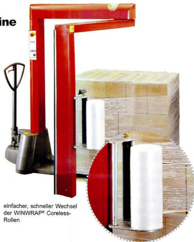
einfacher, schneller Wechsel der WINWRAP® Coreless-Rollen
